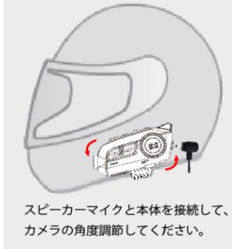
スピーカーマイクと本体を接続して、カメラの角度調節してください。
