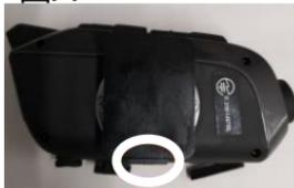
※ヘルメットに沿ってつけるためカメラが傾くので本体の裏のアダプターに角度調節ラバーを挟んで角度を調節してください。(左の図B参照)
