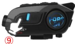
カメラ電源が入っている状態で⑨のフォト&マイク切替ボタンを1回押すとキャプチャーが撮れます。
